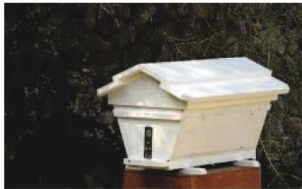
An der Bienen-Akustikstation sind Mikrofone angebracht, die „Bienensprache“ in die Box übertragen.
